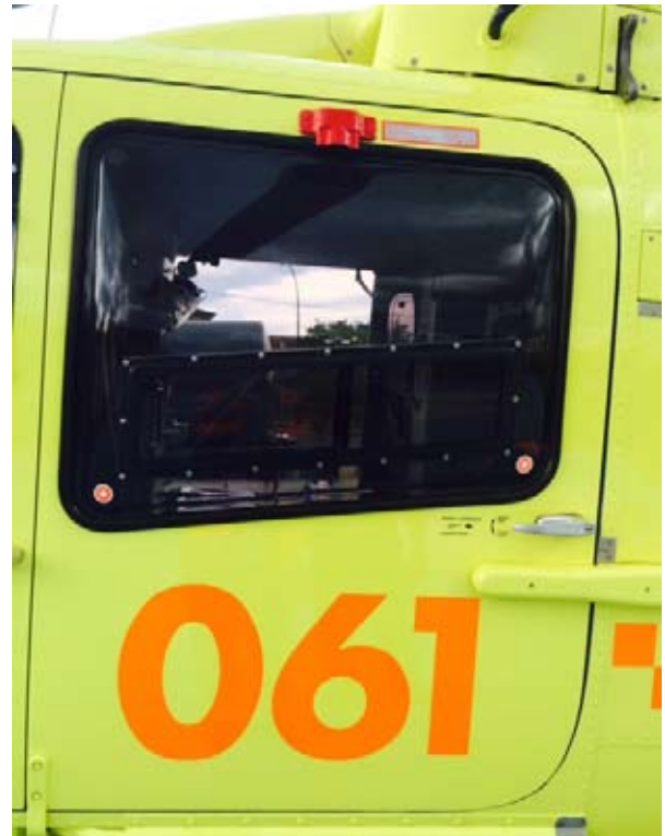
Saída de emerxencia. Tirar da maneta vermella como se indica e empurrar nos puntos vermellos
