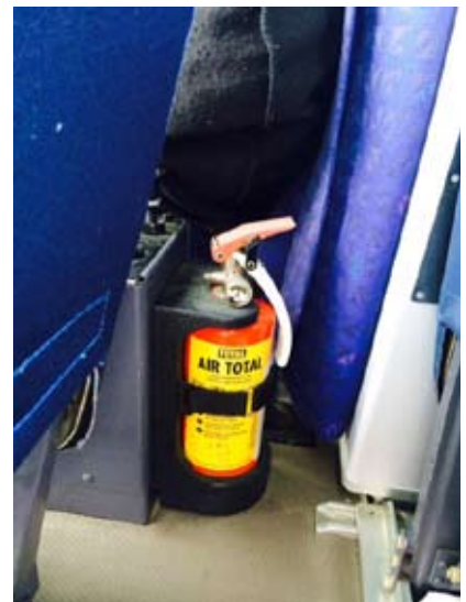
Extintor detrás dos asentos do piloto e o copiloto
