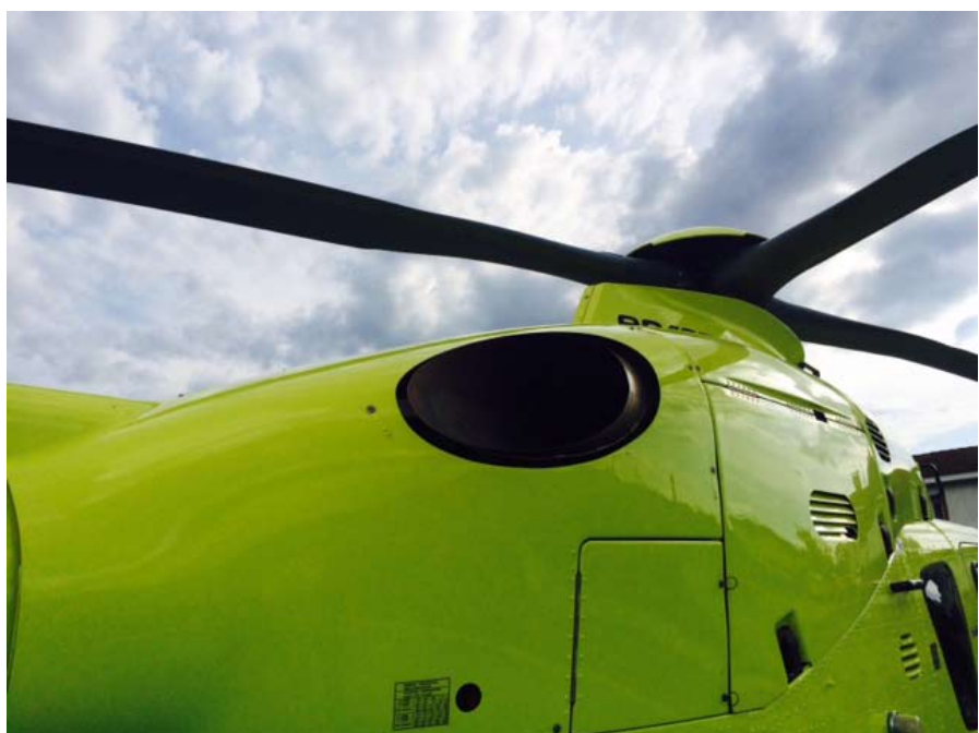
Tobeira do EC-135 con motores acendidos foco de lume
