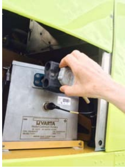
Batería do EC-135. Mecanismo de desconexión da batería
