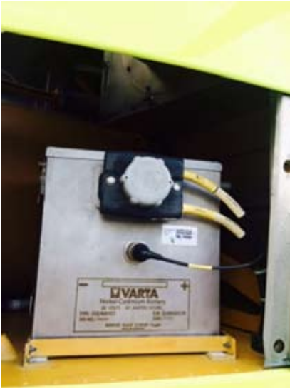
Batería do EC-135. Mecanismo de desconexión da batería
